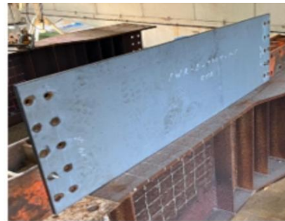
図 2. 座屈試験体(1140mm×370mm×9mm)
