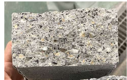
写真-4 曲げ試験後の断面 (黒い点が炭素骨材)
